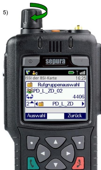
Gruppen der 3. Ebene auswählen, Auswahl der Rufgruppe über den Navigations-Drehknopf mit anschließendem Betätigen der PTT-Taste
