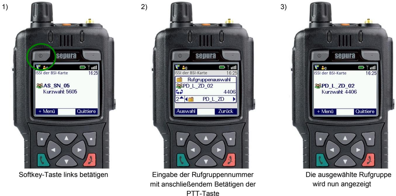
Für die Endgeräte des Freistaates Sachsen ist in der Gruppenstruktur der BRK und PGA bezüglich der Kurzwahl jeweils ein eigenes Rufgruppennummernschema hinterlegt (Details dazu im Fleetmapping). Dieses Schema weist jedem Leitstellenbereich einen festen 4-stelligen Nummernblock zu, der es ermöglicht, dass die Kurzwahl jeder Rufgruppe über die Nutzungsdauer des Endgerätes weitestgehend konstant bleibt, um eine vereinfachte Bedienung zu ermöglichen.
