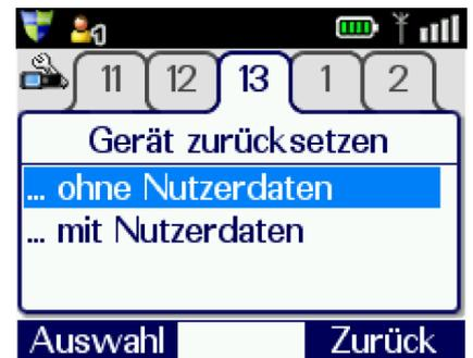
Wird die entsprechende Abfrage (Abb. 1, Abb. 2) bestätigt, schaltet sich das Endgerät automatisch aus und startet neu. Das Endgeräte wird auf die Grundeinstellung der AS Sachsen zurückgesetzt.
